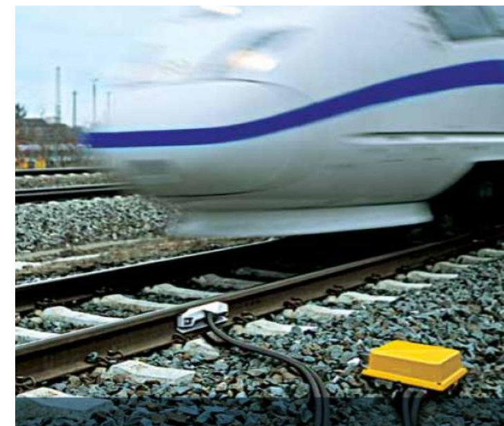
Принцип действия индуктивного колесного датчика ZP43
